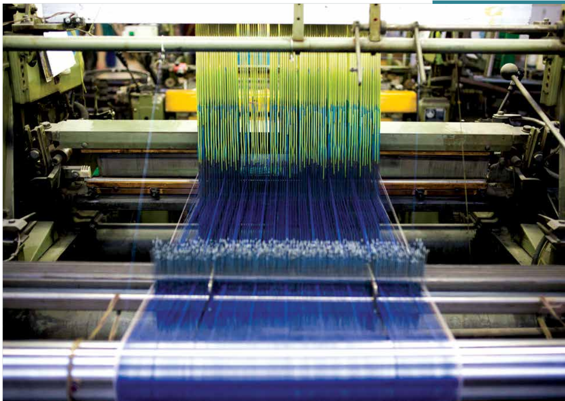
Les écharpes Tailleur sont tissées sur un métier Jacquard comme celui-ci à Biella, en Italie. The Suit scarves are knitted on Jacquard looms like this one in Biella, Italy. © Chargeurs SA
